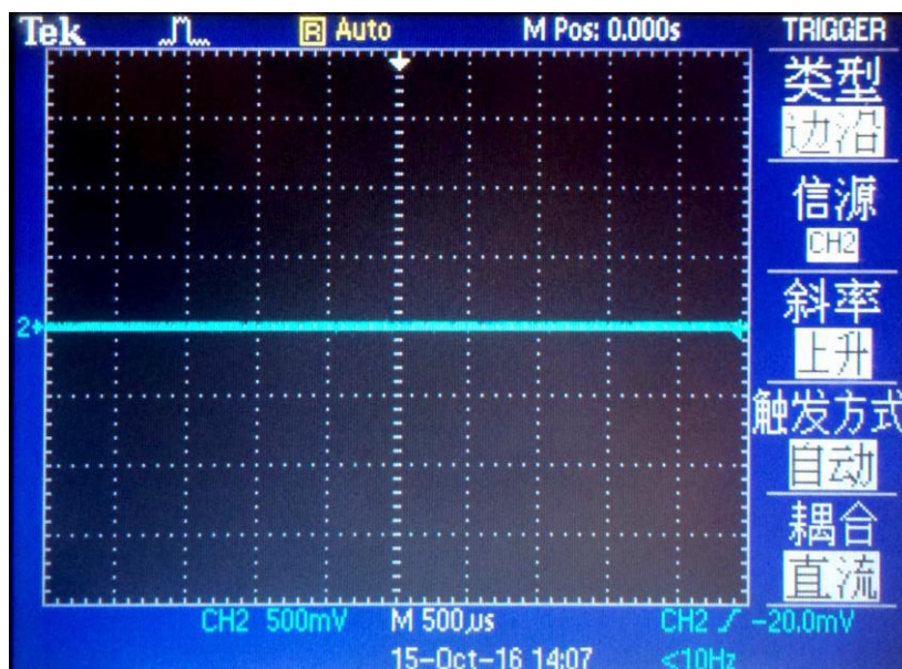
图 2-10-4 Fast 模式下 CH1 输出 R 信号波形（ 1\text{ms} 6dB/oct）
